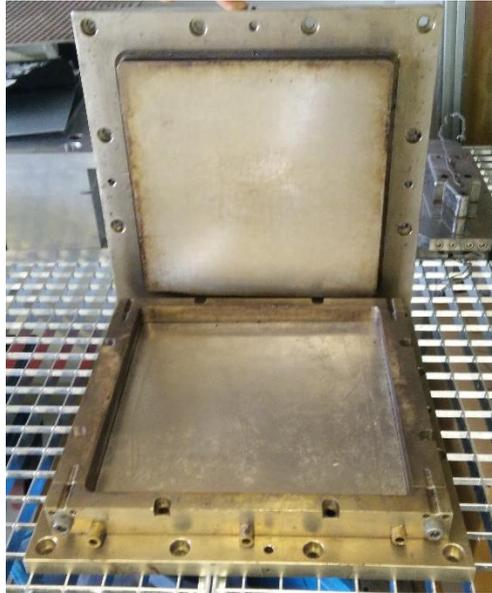
Abbildung 49: Werkzeug Platte 300 mm x 300 mm
