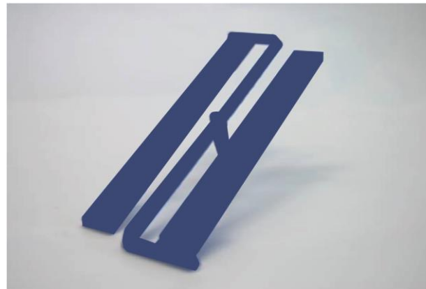
Abb. 18: Probengeometrie, Werkzeugkassette und Bauteil der „Stäbe für Flammstutztests“; Links: Stab für DIN EN ISO 4589 (LOI), Rechts: Stab für UL94
