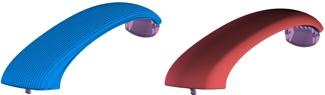
Abb. 35: Werkzeug und Demobauteil des 2K-Wendepplattenwerkzeuges Deckel Mittelarmlehne Mini 60
