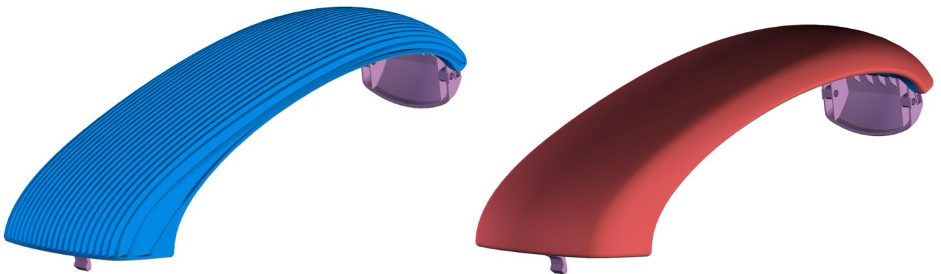
Abb. 35: Werkzeug und Demobauteil des 2K-Wendeplattenwerkzeuges Deckel Mittelarmlehne Mini 60
