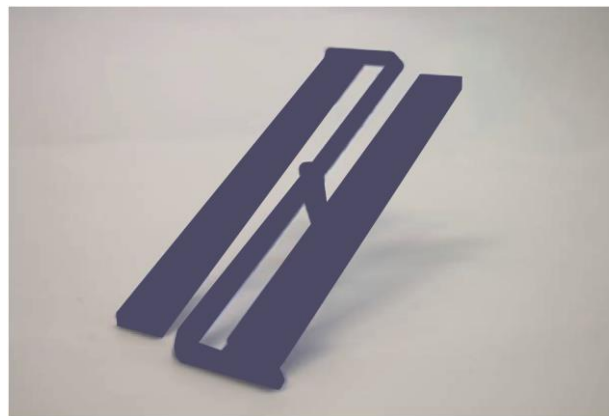
Abb. 18: Probengeometrie, Werkzeugkassette und Bauteil der „Stäbe für Flammenschutztests“; Links: Stab für DIN EN ISO 4589 (LOI), Rechts: Stab für UL94
