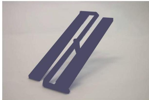
Abb. 18: Probengeometrie, Werkzeugkassette und Bauteil der „Stäbe für Flammstutztests“;
