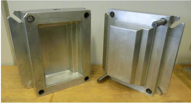
Abb.45: Werkzeug Stufenwanne
