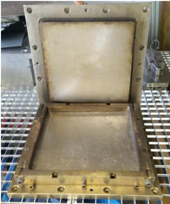
Abb.45: Werkzeug Platte 300 mm x 300 mm
