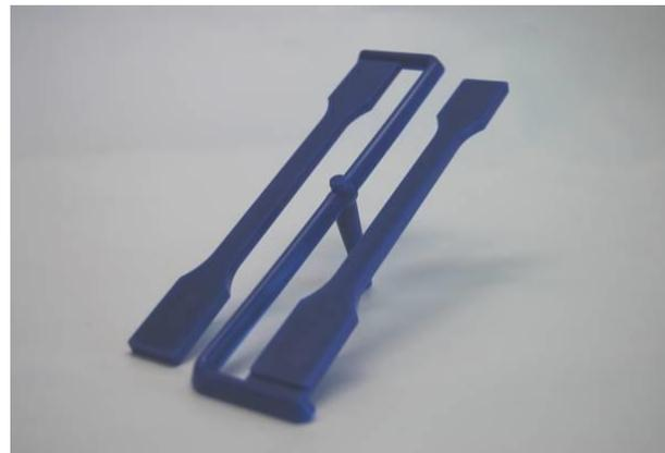
Abb. 13: Probengeometrie, Werkzeugkassette und Bauteil des „Campus-Zugstabs“
