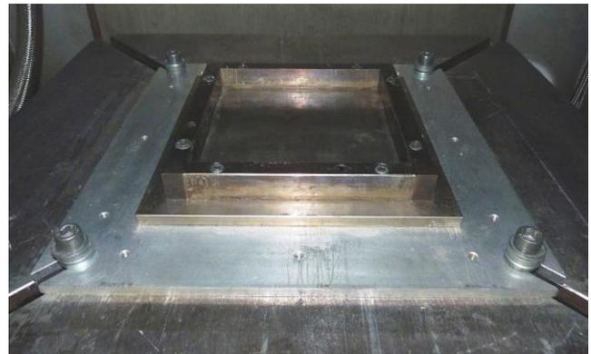
Abb.43: Werkzeug Platte 210 mm x 210 mm
