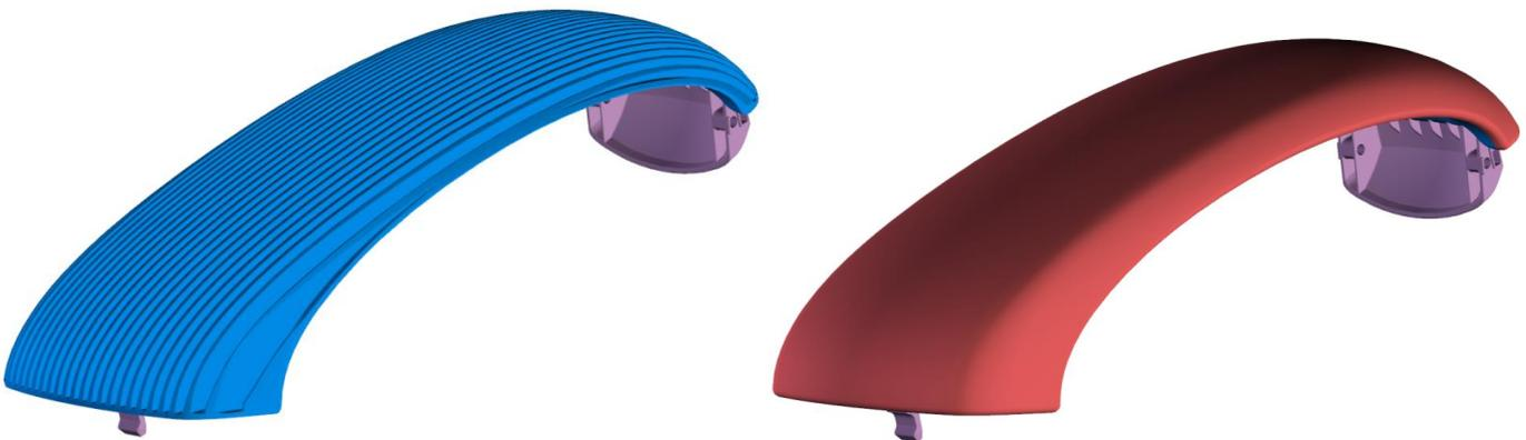
Abb. 34: Werkzeug und Demobauteil des 2K-Wendepplattenwerkzeuges Deckel Mittelarmlehne Mini 60
