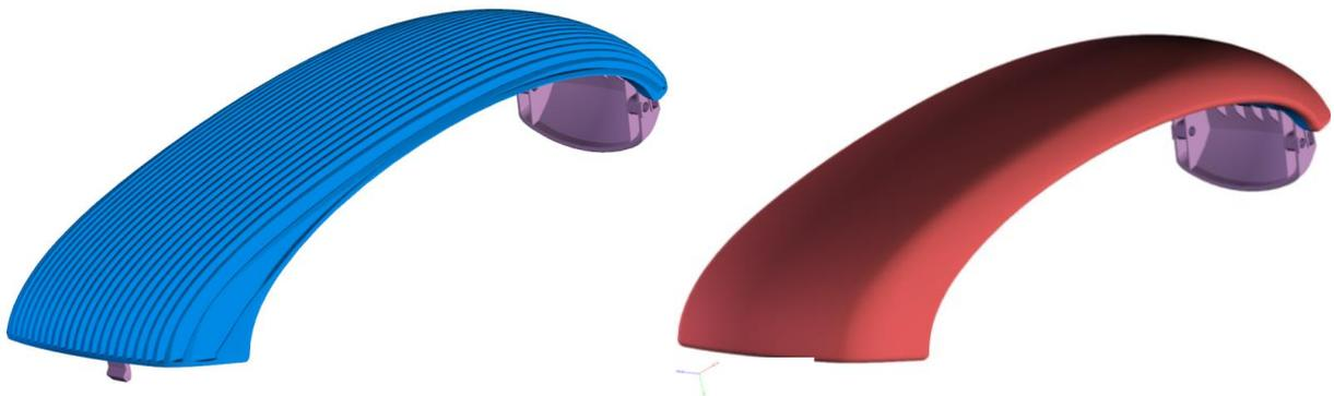
Abbildung 39: Werkzeug und Demobauteil des 2K-Wendeplattenwerkzeugs Deckel Mittelarmlehne
