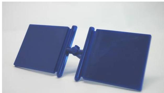
Abbildung 24: Probengeometrie, Werkzeugkassette und Bauteil der „Platte 70 x 70 mm“
