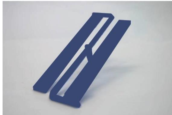
Abbildung 22: Probengeometrie, Werkzeugkassette und Bauteil der „Stäbe für Flammschutztests“
