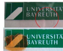
Oben: ZnO-Polystyrol-Nanocomposite (40 gew.% ZnO) Unten: CdSe-Polystyrol-Nanocomposite (10 gew.% CdSe)
