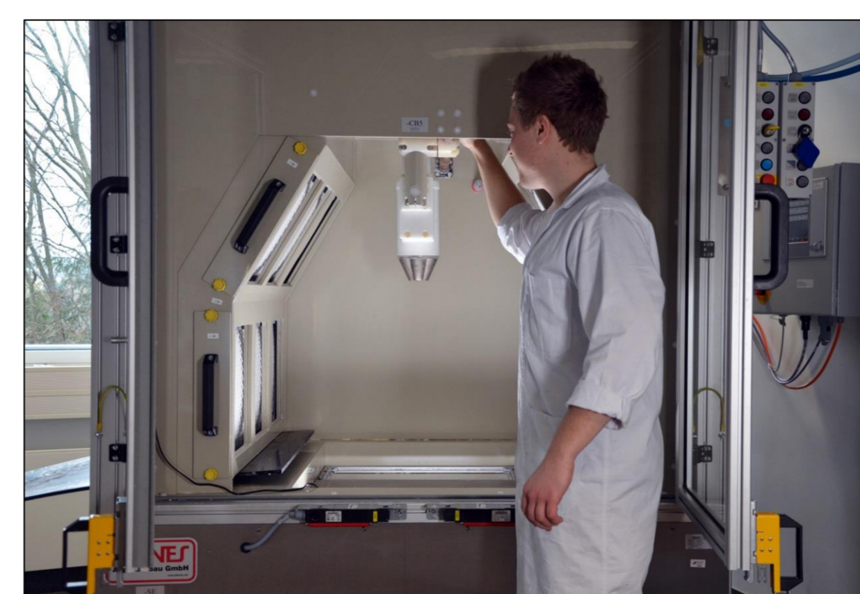
Zentrifugenspinnanlage: Neuartige Technologie zur skalierbaren Herstellung von Submikron- bis Nanofasern auf Biopolymerbasis.
