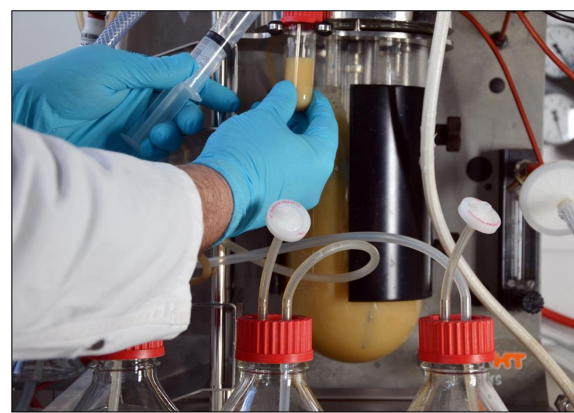
Proteinproduktion und Fermentation zur Herstellung von z.B. rekombinanten Spinnseidenproteinen als gängiges Verfahren.
